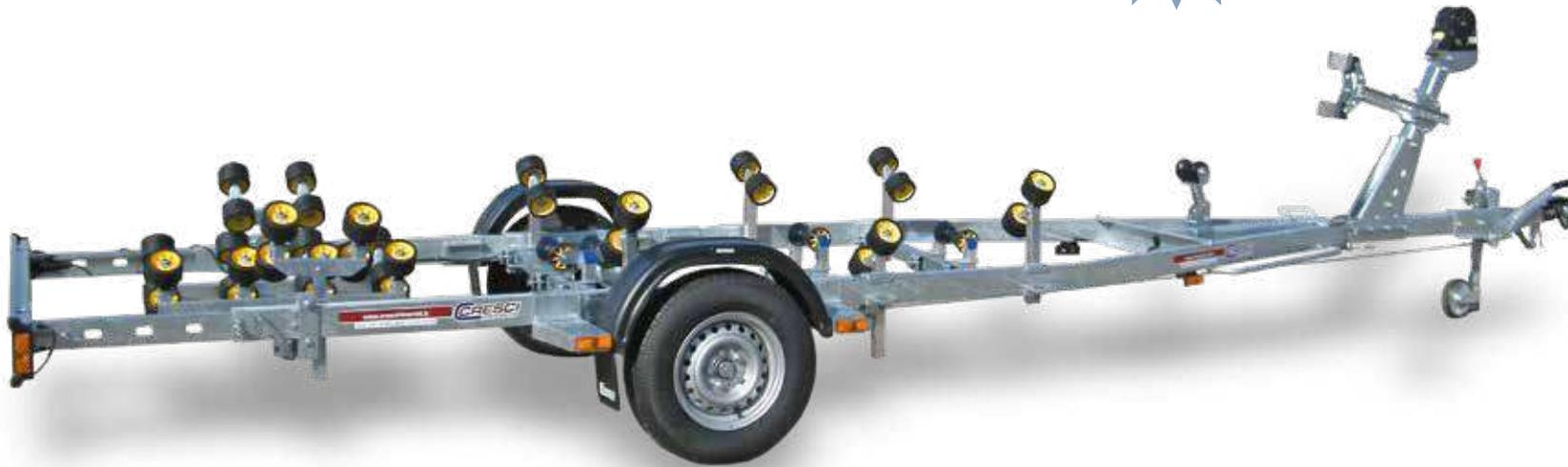
Traversa posteriore basculante di serie (multirullo)
